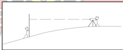
Gambar 4. 8 Pembacaan Rambu Ukur
