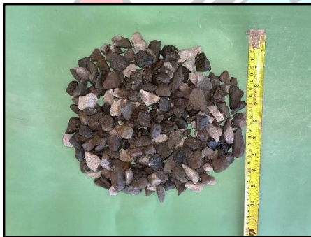
Kondisi agregat kasar (1-2 cm)
