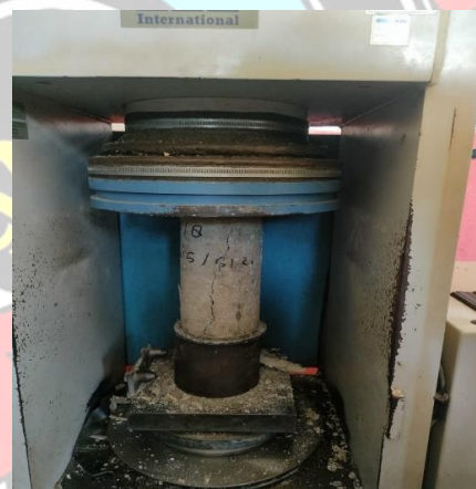
Kondisi setelah diuji
