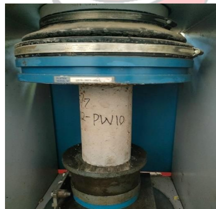
Uji tekan Sampel SW-PW
