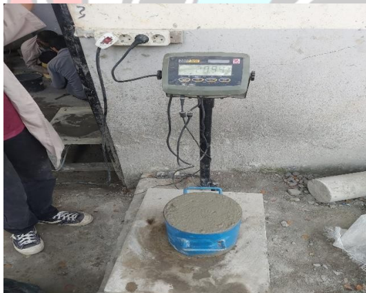
Uji berat beton basah
