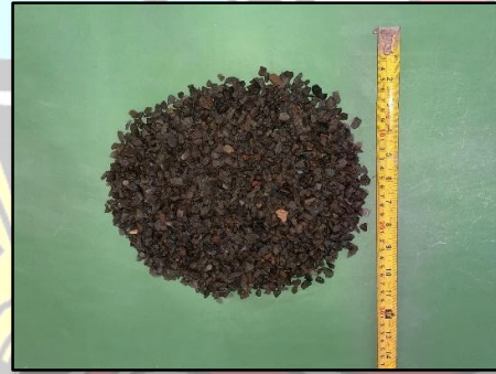
Kondisi agregat kasar (0,5-1 cm)
