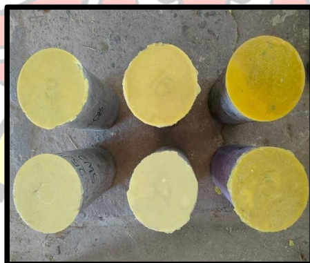
Kondisi selesai capping
