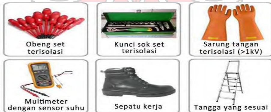
Gambar 3.4 Alat Keselamatan dan Alat Kerja dalam Pengoperasian PLTS Hybrid
