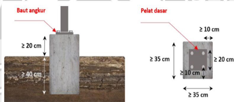
Gambar 2. 15 Pondasi Rangkaian Panel Surya yang Disarankan (Sumber gambar: buku "Instalasi Pembangkit Listrik Tenaga Surya Dos & Don'ts")
