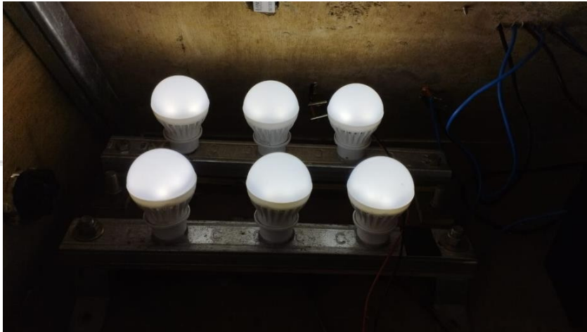
Gambar 4.4 Modul Instrumen Pembangkit Hybrid dan Beban DC 6 buah lampu
