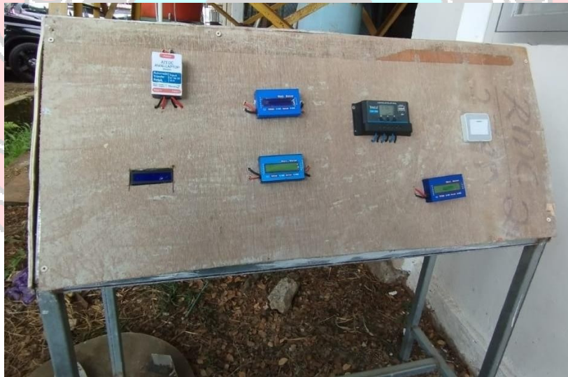
Gambar 4.3 Modul instrumen tempat pembacaan data dan ATS
