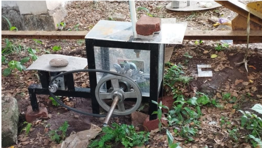
Gambar 4.2 Turbin Pelton Tercopel dengan generator DC
