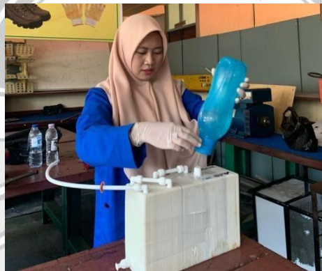
Proses Penambahan Larutan Elektrolit pada Elektroda Generator HHO
