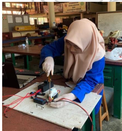
Proses Pemasangan Instalasi Kelistrikan dari PWM ke Generator HHO
