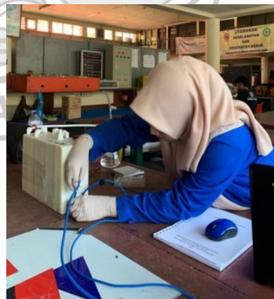
Proses Pemasangan Instalasi Kelistrikan dari PWM ke Generator HHO
