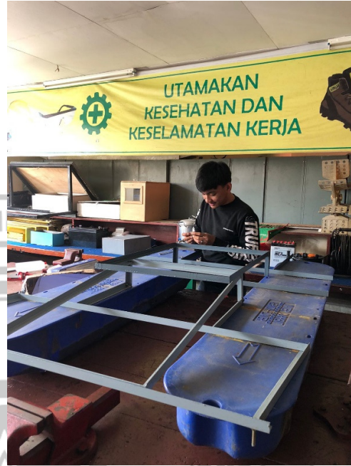
Proses pembuatan Rangka PLTS Terapung
