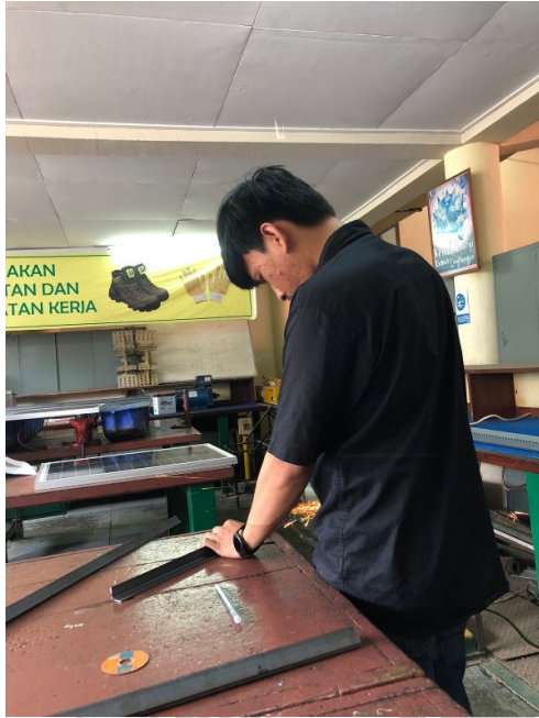
Proses pembuatan Rangka PLTS Terapung
