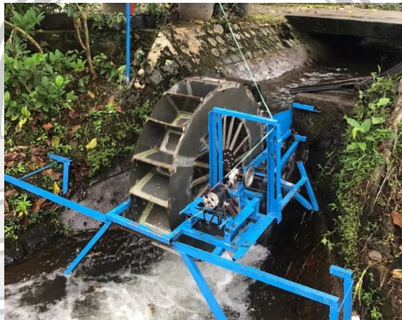
Gambar 2. 2 Pembangkit Listrik Tenaga Piko hidro (Sumber: deliknews.com)
