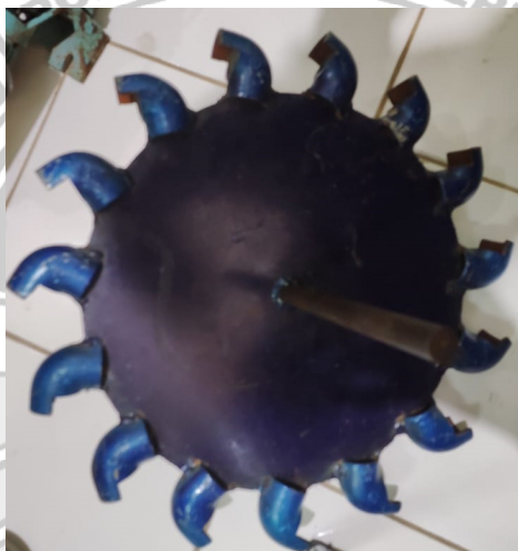
Gambar 2. 3 Turbin Air (Sumber: Prototipe Turbin Air Pelton)
