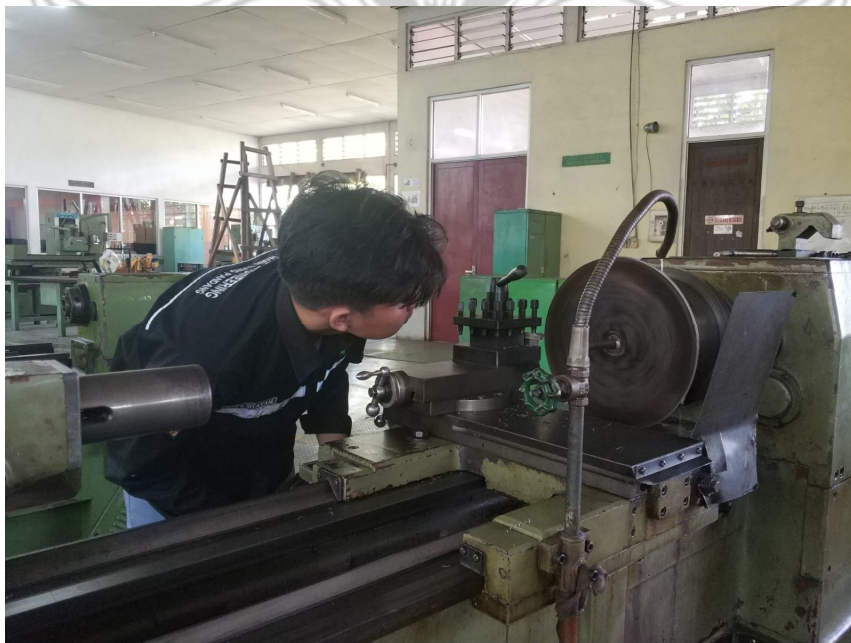
Proses pembubutan Piringan Turbin
