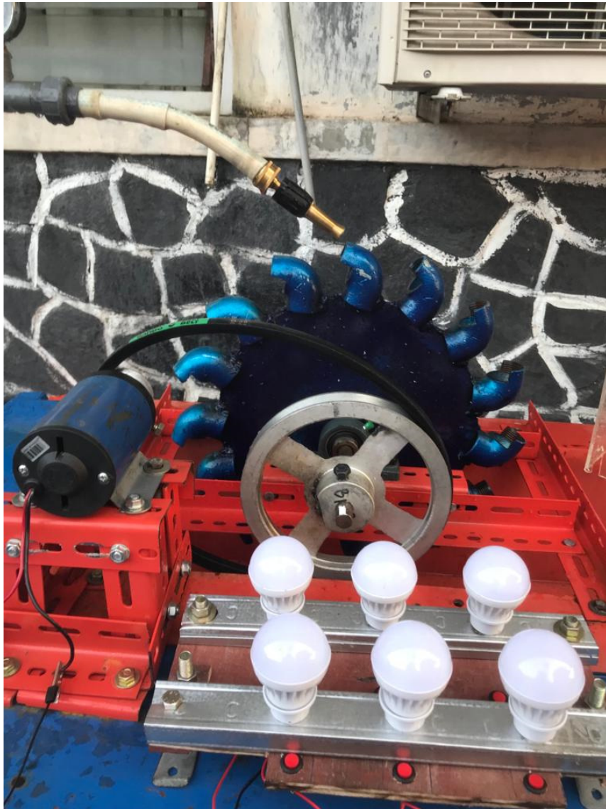
Rangkaian Turbin Dengan Diameter Sudu 1 Inci
