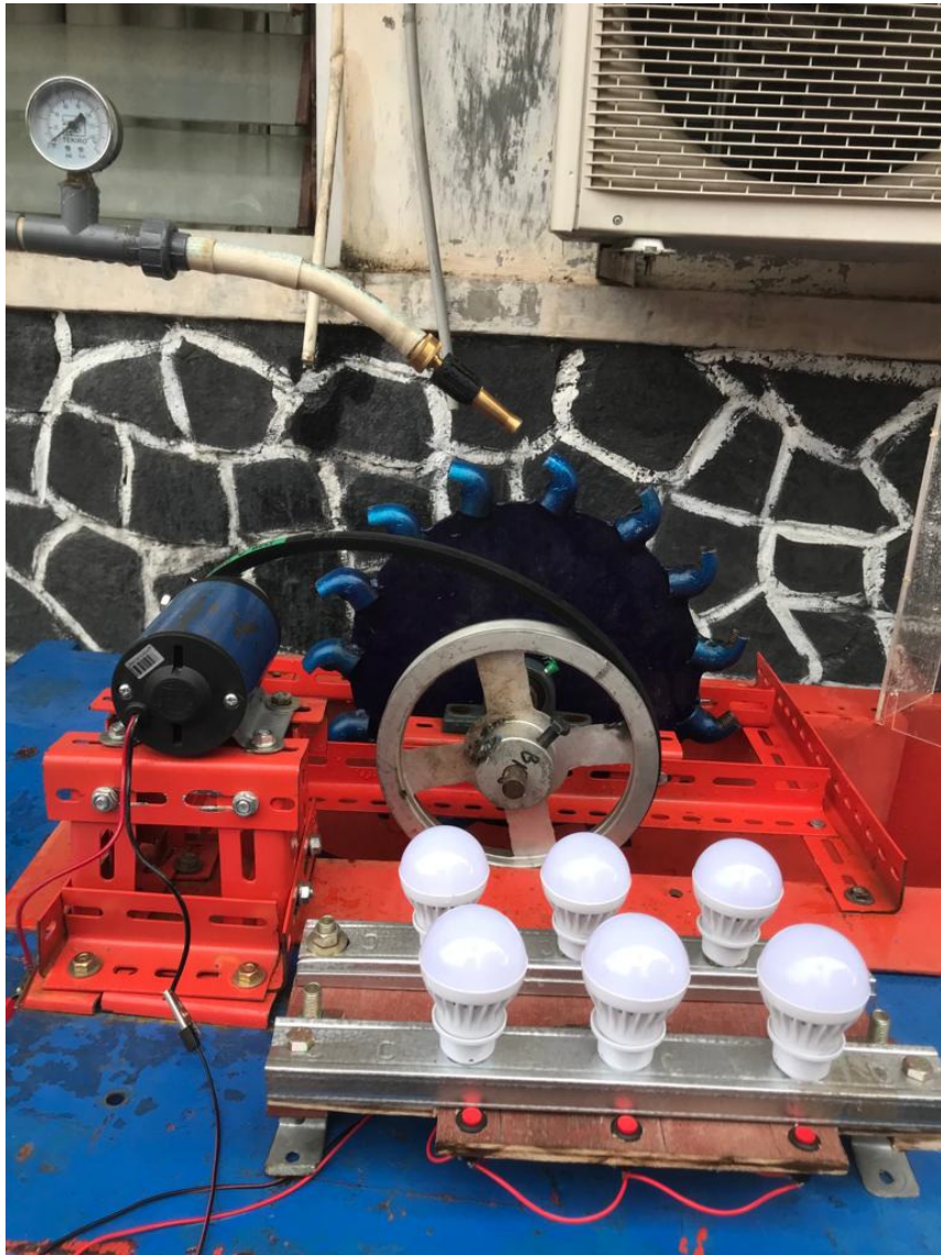
Rangkaian Turbin Dengan Diameter Sudu 1/2 Inchi
