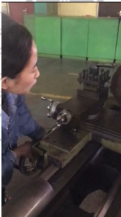
Proses pembubutan Piringan Turbin
