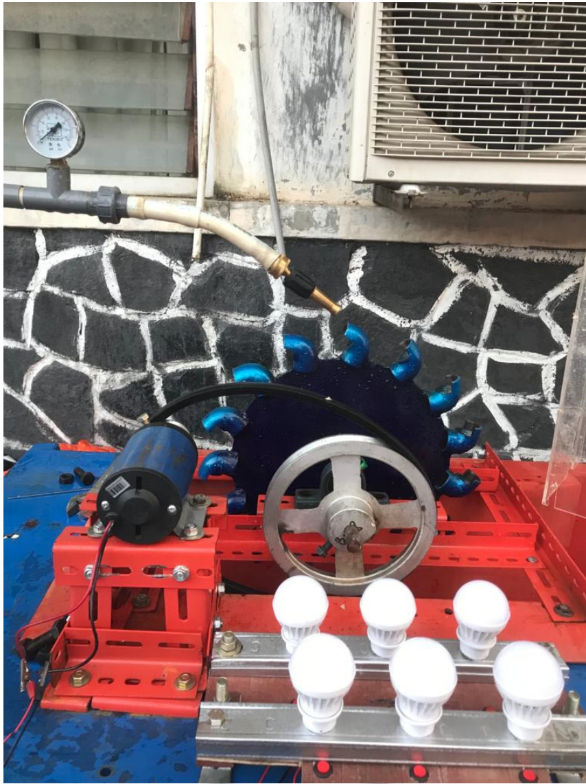
Rangkaian Turbin Dengan Diameter Sudu \frac{3}{4} Inchi
