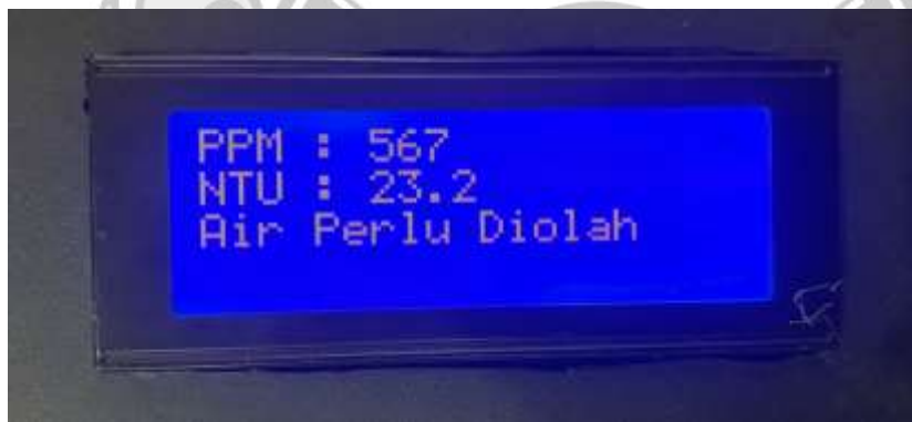
Lampiran 23 Kondisi Sistem Saat Air tidak Memenuhi Standar
