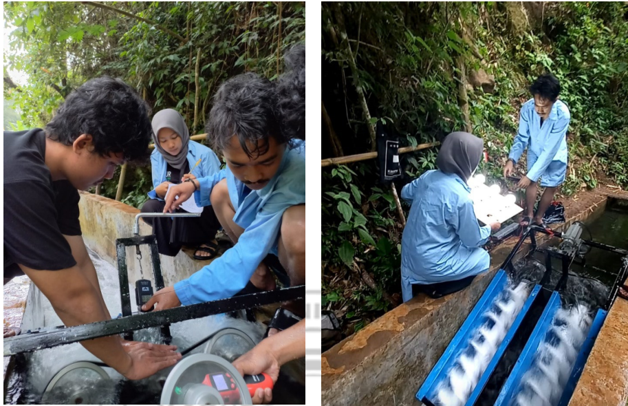
Gambar 8 Pengambilan Data Torsi Dan Beban Lampu
