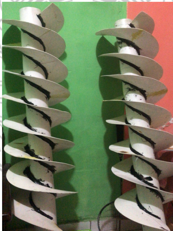
Gambar 2 Pemasangan ulir ke poros turbin
