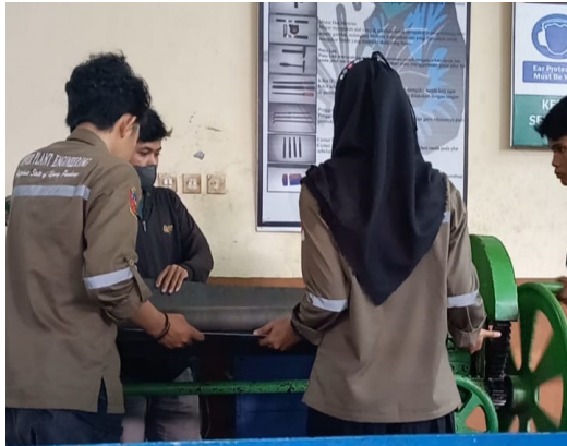
Gambar 3 Pembuatanudukan turbin berbentuk U dengan menggunakan mesin roll Plat
