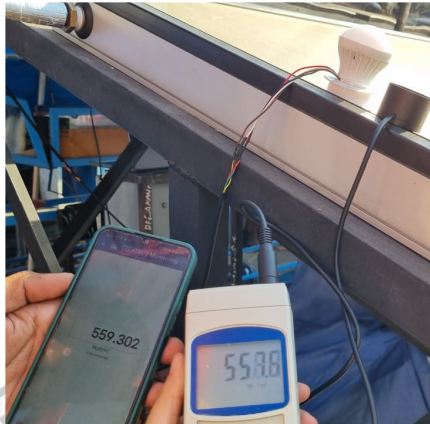
Gambar 4.6 Pengkalibrasian Alat Dengan Solar Power Meter
