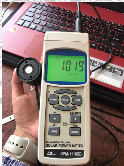
Gambar 19 Intensitas matahari pada solari meter
