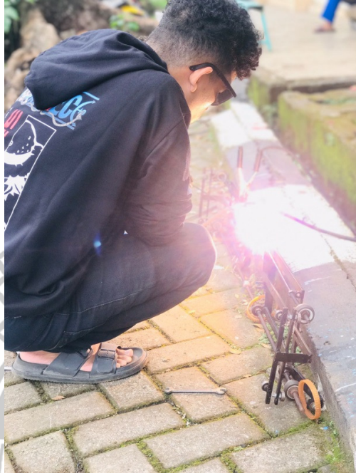
Gambar 9 Pengelasan rangka untuk membuat dudukan pipa
