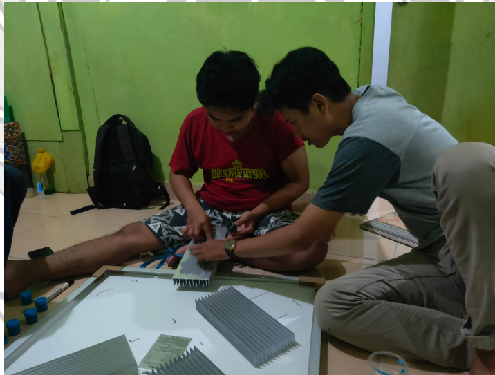
Pemasangan thermal glue pada Heatsink
