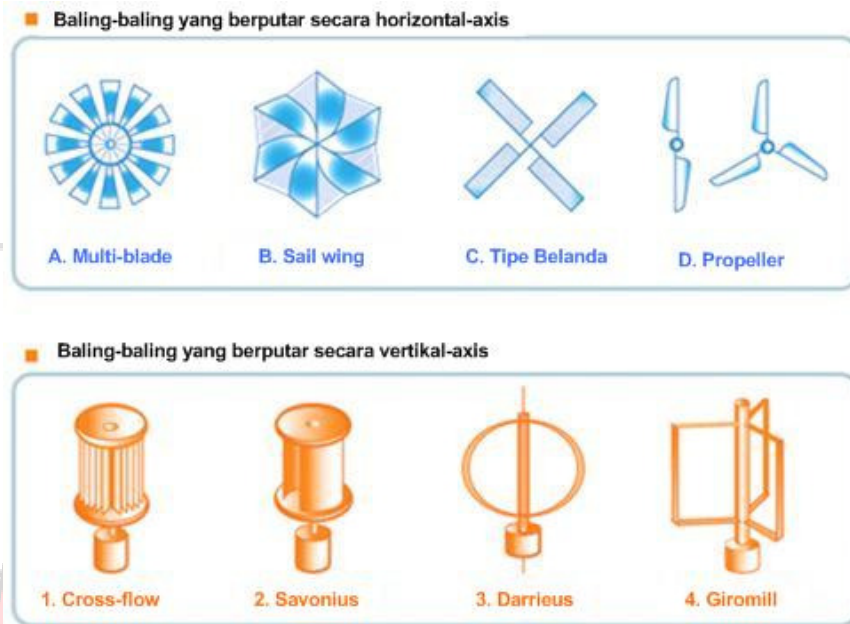
Gambar 2.1 Jenis-jenis turbin angin (Sumber: indone5ia.wordpress.com,2022)
