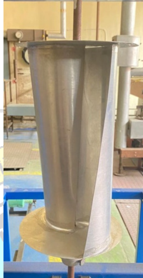
Gambar 4.3 turbin savonius 2 sudu modifikasi
