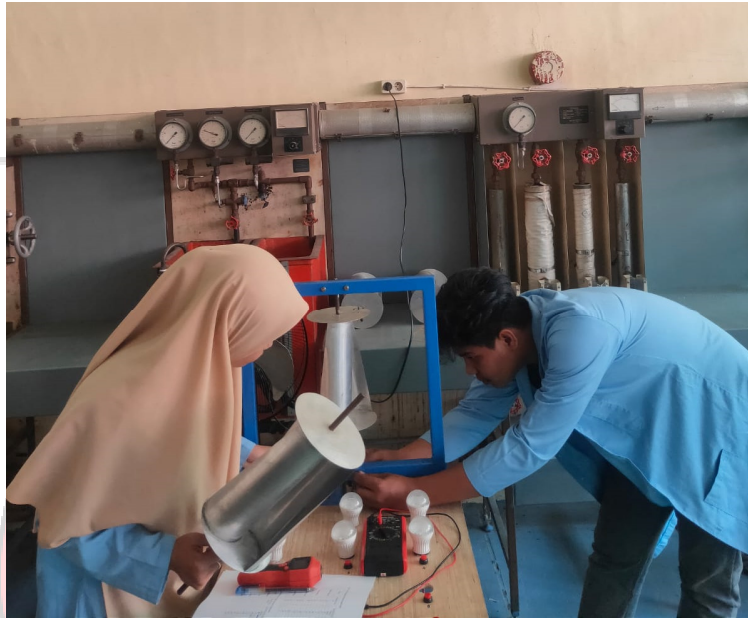
Gambar pemasangan turbin
