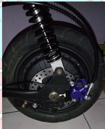
Gambar 4.5 Rem Hidrolik Setelah Terpasang
