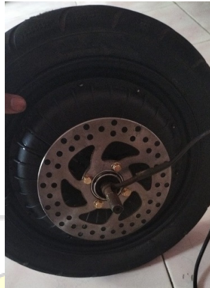
Gambar 4.4 Pemasangan Piringan Cakram pada Motor BLDC
