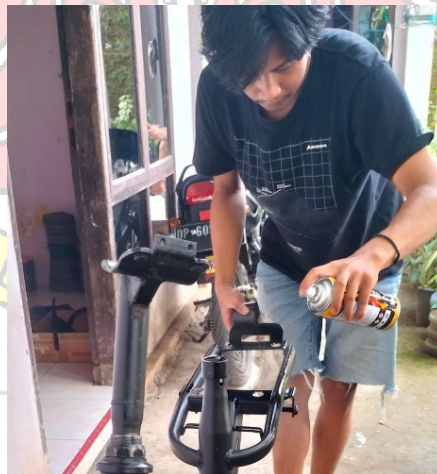
Gambar 4.2 Proses Pengecatan Rangka
