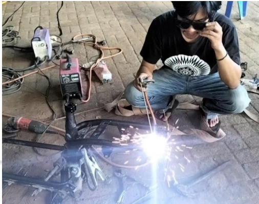
Gambar 4.1 Proses Pengelasan Rangka Sepeda
