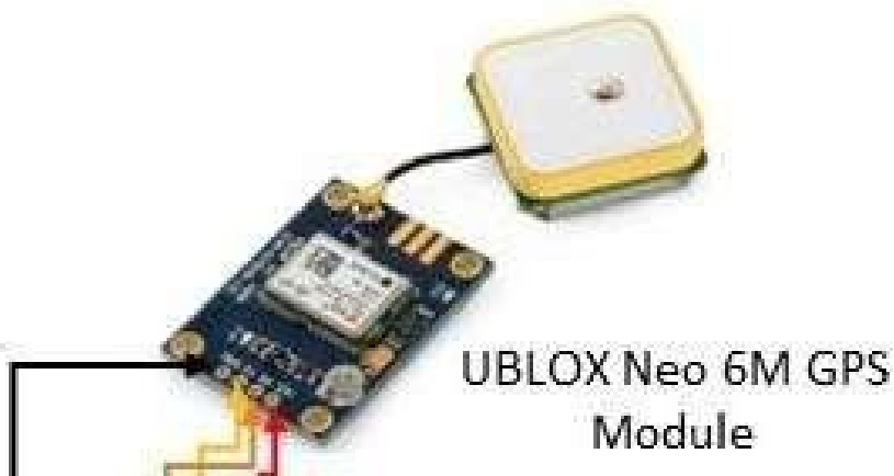
Gambar 2. 8 GPS Module UBLOX Neo 6M GPS
