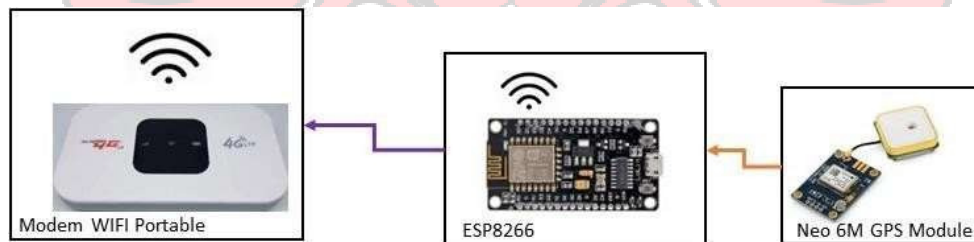
Gambar 3. 4 Sistem IoT Drone Pengantar Barang
