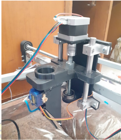
Gambar 25 Pemasangan dudukan penanam benih
