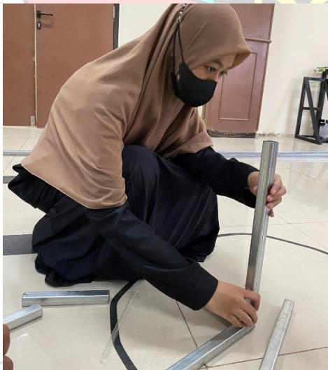
Pembuatan rangka alat dari besi hollow
