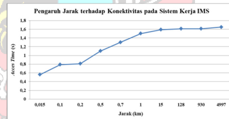
Gambar 4.27 Tampilan Grafik Pengaruh Jarak terhadap Konektivitas pada Sistem Kerja IMS. (Sumber : Microsoft Excel)
