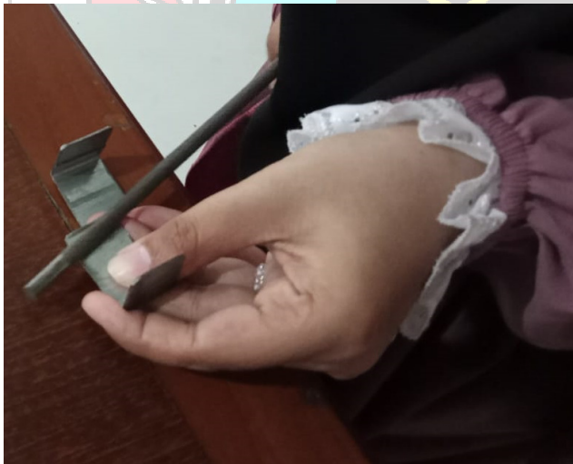
Gambar 4.1 Membuat dudukan Sensor SMC D-A73 (Sumber : Dokumentasi Pribadi Fera dan Popy)
