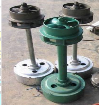
Gambar 4. Pembangkit Listrik Tenaga Picohydro Tipe Propeller
