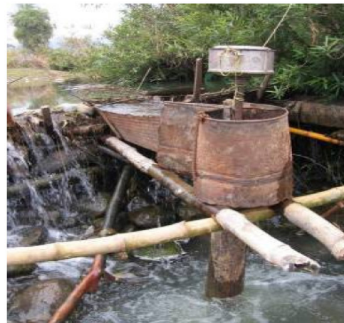
Gambar 8. Pemasangan picohydro dengan menggunakan basin.
