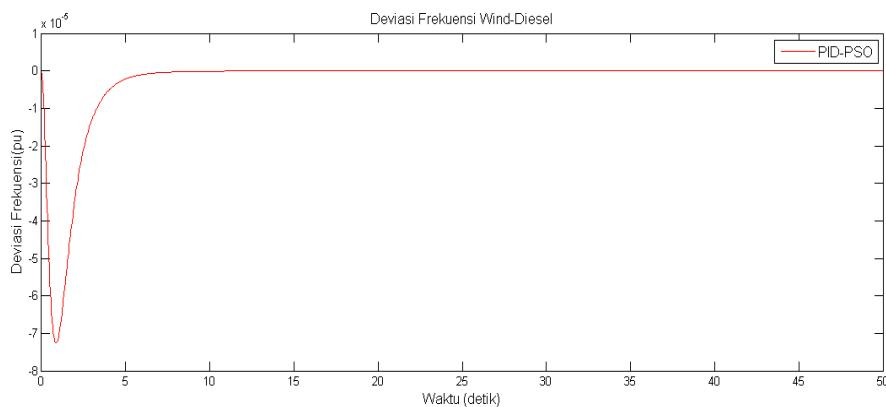
**Gambar 8. Grafik respon frekuensi Wind-Diesel yang dilengkapi controller**
