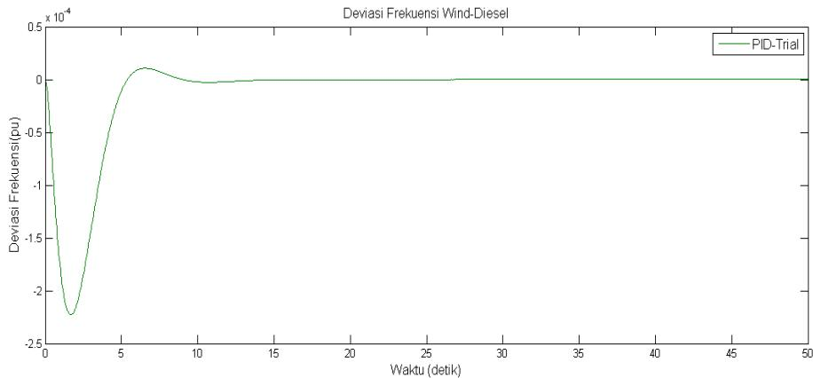
**Gambar 7. Grafik respon frekuensi Wind-Diesel dengan controller PID-Trial**
