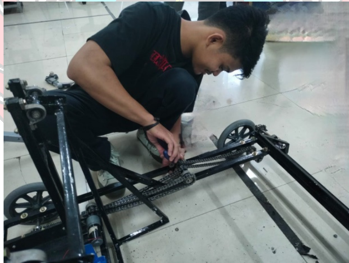
Gambar 4. 3 Proses Pemasangan Rantai dan Sproket
