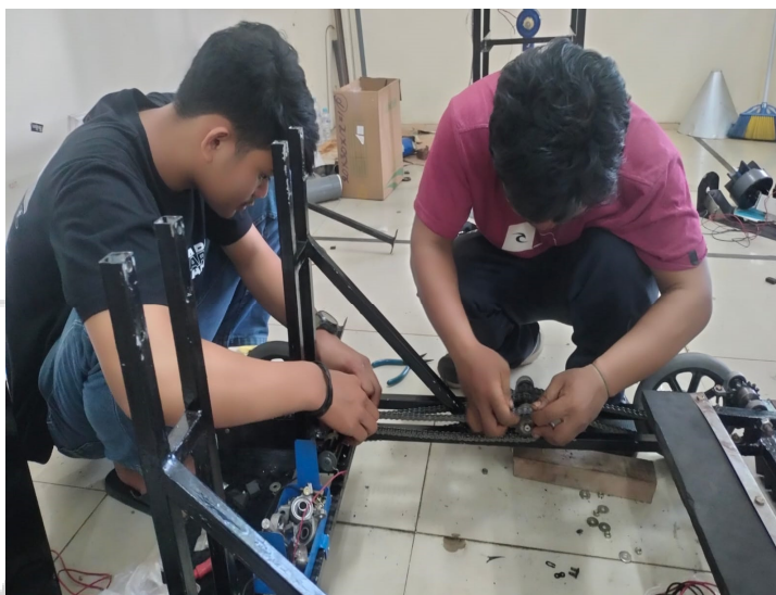
Proses Pemasangan Motor Roda dan Motor Power Window
