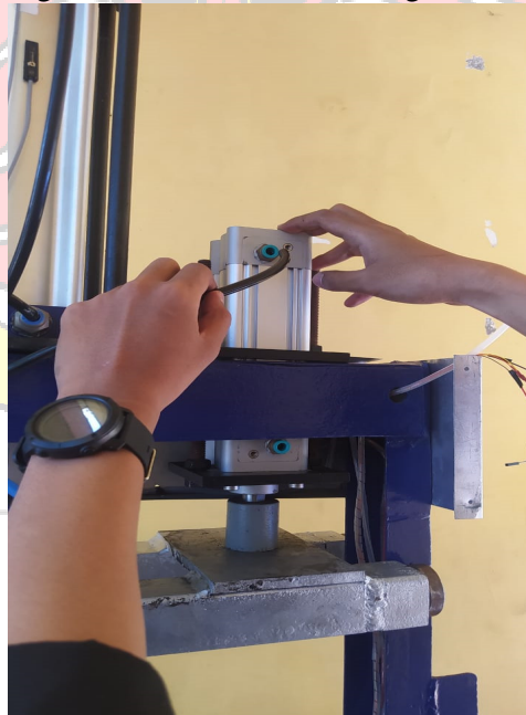
Pemasangan Selang Untuk Penyaluran Udara Bertekanan
