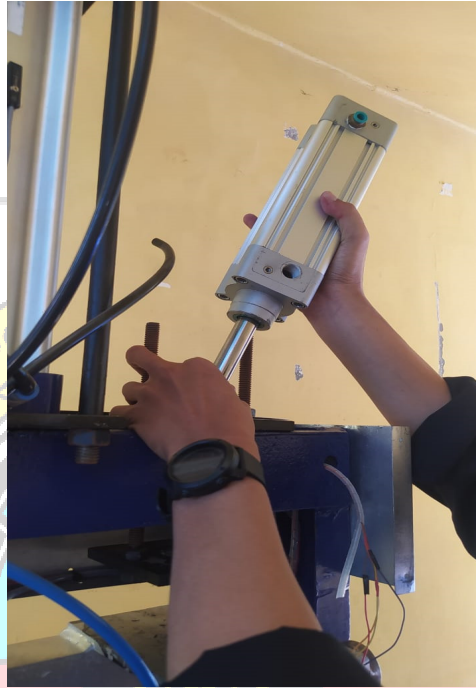
Pemasangan Silinder Pnematik Sebagai Pembebanan
