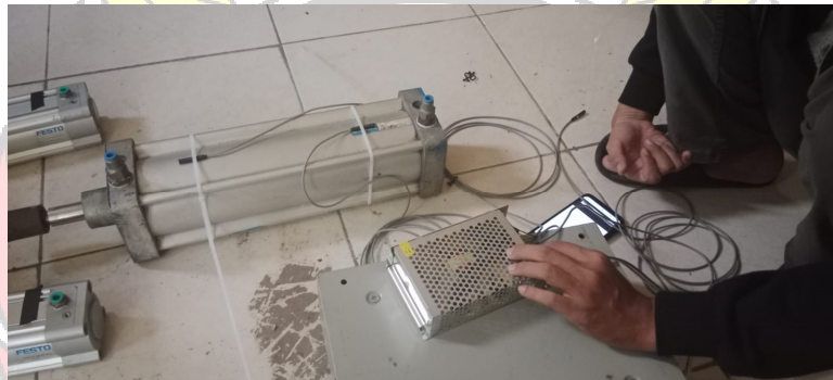
Pengujian Sensor Sebelum di Pasang Pada Alat Uji Suspensi
