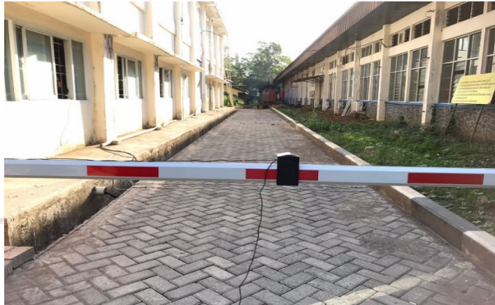
Gambar 4. 2 Hasil Pemasangan Kamera pada Palang Setelah pemasangan kamera pada bagian tengah palang maka dapat dilihat hasil perancangan mekanik sistem parkir pada Gambar 4.3.
