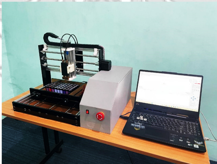
Gambar 4. 2 Mesin CNC spot welding untuk battery pack
