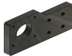
Gambar 2. 22 Bracket Stepper Axis X (Sumber: Desain Pribadi, 2023)
