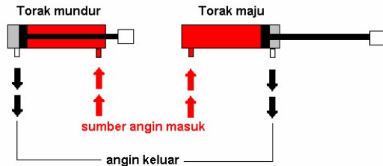
Gambar 2.18. gerakan piston pneumatik
