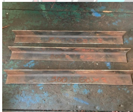
Gambar 4.9 Sampel Setelah di Tekuk
