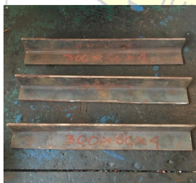
Gambar 4.11 Sampel Setelah di Tekuk t :4mm
