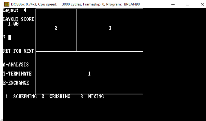
Gambar 4.18 layout Alternatif 1 Berdasarkan Nilai R-Score Terbaik (untuk Produksi Briket pada lantai produksi 500 cm x 500 cm)
