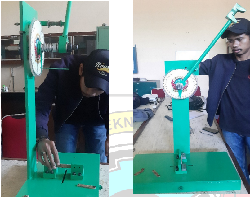
Gambar 4.6. Proses pengujian komposit dengan menggunakan alat uji dampak charpy
