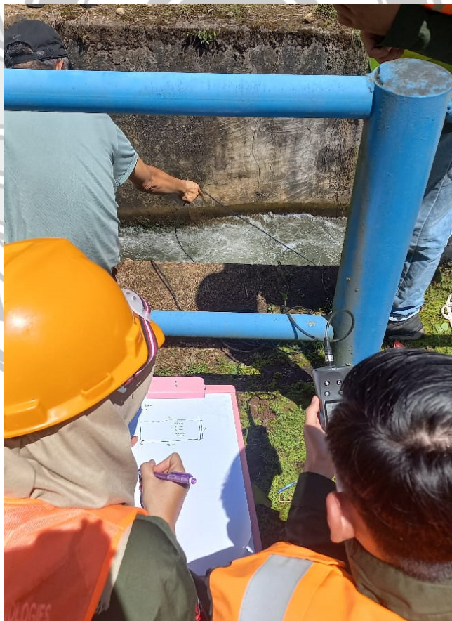
Lampiran 2. Pengukuran ketinggian air dan kecepatan aliran pada saluran tailrace
