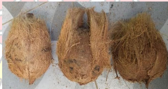
Gambar 4.5 Hasil pengupasan kecepatan Blade 85 rpm (kelapa besar)
