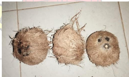
Gambar 4.4 Hasil pengupasan kecepatan blade 45 rpm (kelapa besar)
