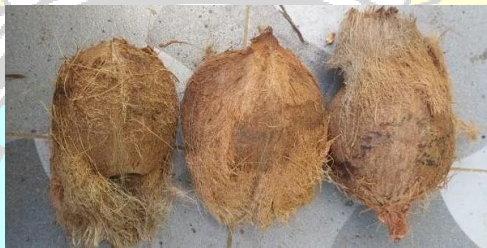
Gambar 4.3 Hasil pengupasan kecepatan Blade 68 rpm (kelapa kecil)
