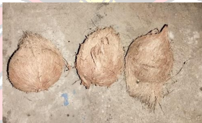
Gambar 4.3 Hasil pengupasan kecepatan blade 45 rpm (kelapa kecil)
