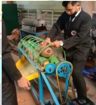
Gambar 1.1 Pengoperasian alat pengupas sabut kelapa modifikasi sebelumnya (Sumber : Setiawan, dkk (2018))
