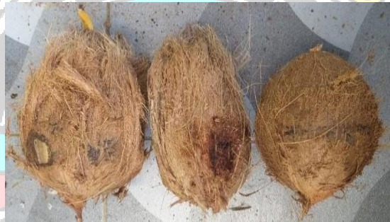
Gambar 4.4 Hasil pengupasan kecepatan Blade 85 rpm (kelapa kecil)
