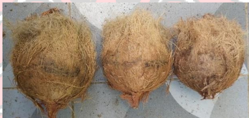
Gambar 4.3 Hasil pengupasan kecepatan Blade 68 rpm (kelapa besar)
