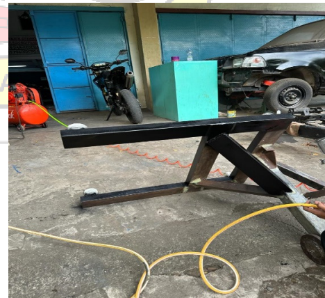
R. Pengecatan rangka utama
