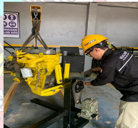
P. Pemasangan engine pada stand
