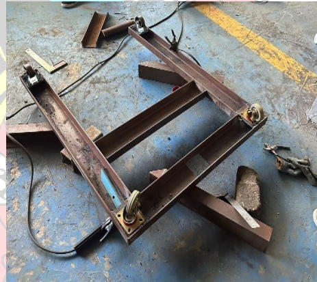
D. Pemasangan roda
