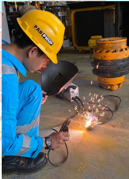
Mengelas gear kecil dengan besi pipa
