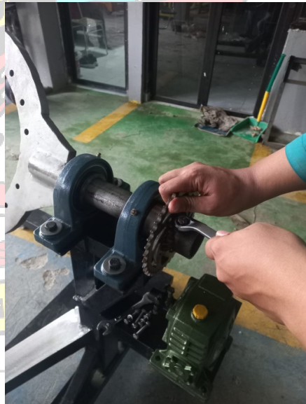
Memasang Gear besar pada Shaft
