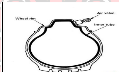
Gambar 2.30 Konstruksi ban bias dan ban dalam
