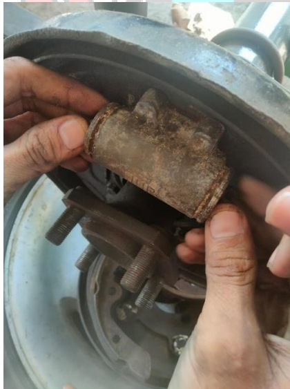
Gambar korosi dan kebocoran pada silinder roda
