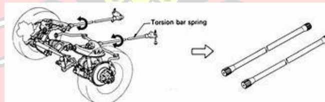
Gambar 2.11 Pegas batang torsi
