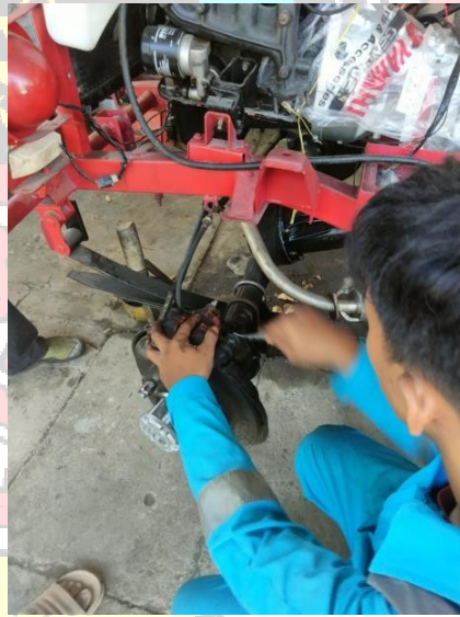
Membuang Udara pada rem depan
