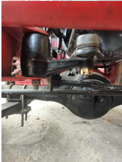
Pemasangan link kemudi
