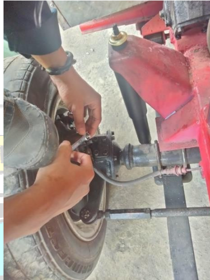
Membuang udara pada rem belakang
