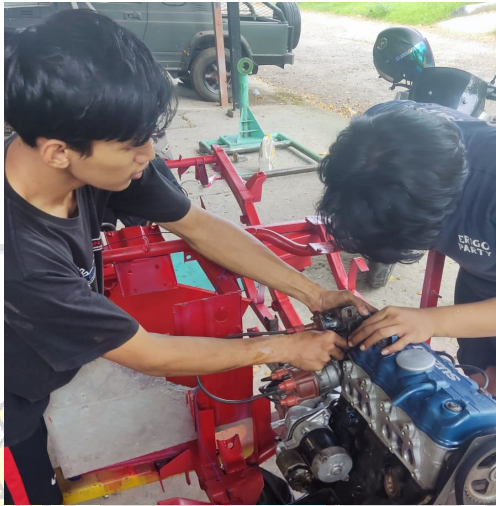
Gambar Pemasangan Coil
