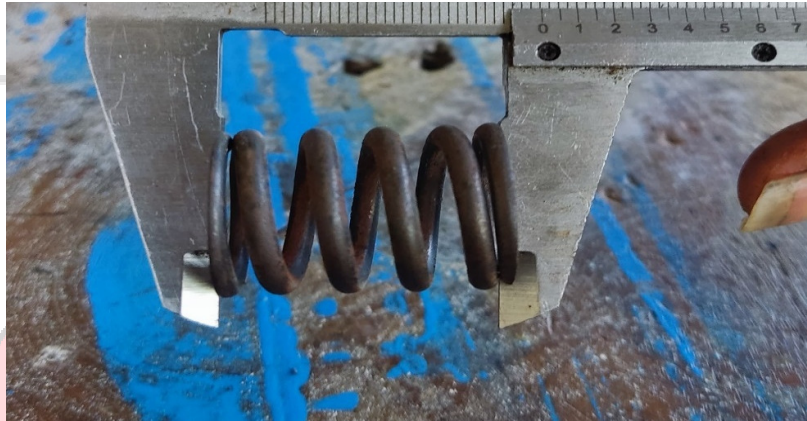
Gambar Pengukuran tinggi pegas katup
