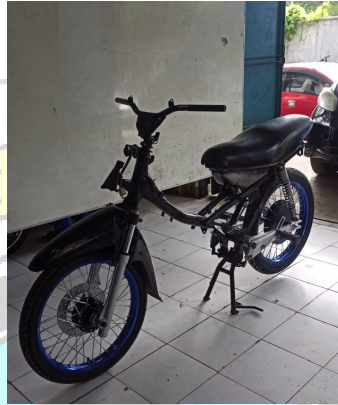
Gambar 4.10 Perakitan Motor BLDC 1000w 48V
