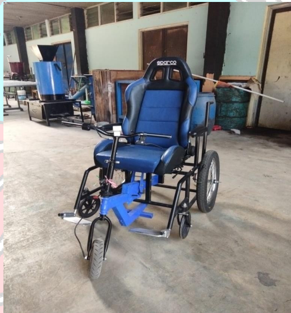
Gambar 4. 1 Hasil pembuatan kursi roda untuk penyandang disabilitas dengan penggerak motor skuter listrik
