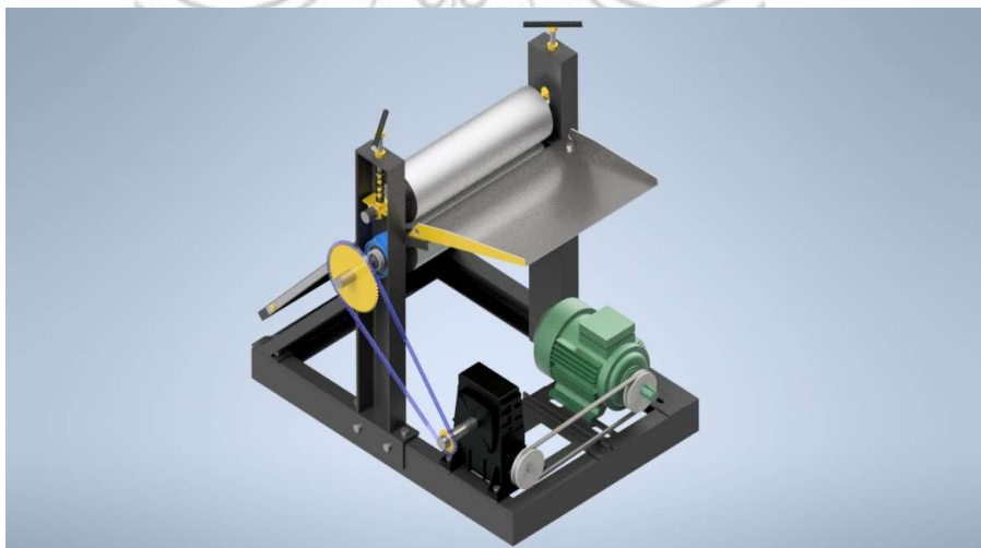
Gambar 1. Rancangan Mesin Pemipih Eceng Gondok
