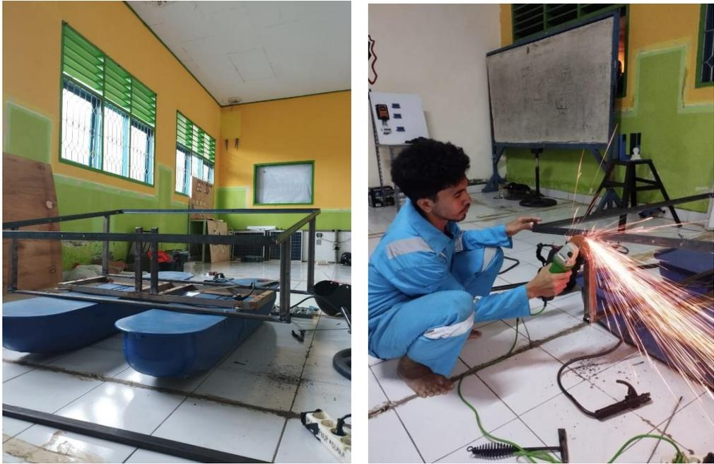
Gambar 11. Proses Pembuatan Rangka Mekanik.
