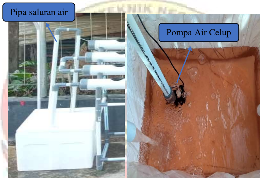
Gambar 4.2 Hasil Perancangan instalasi pipa dan pompa
