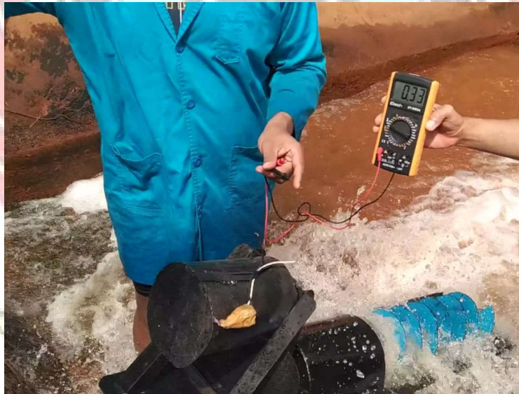
Gambar 17 Pengujian pada Tegangan Generator
