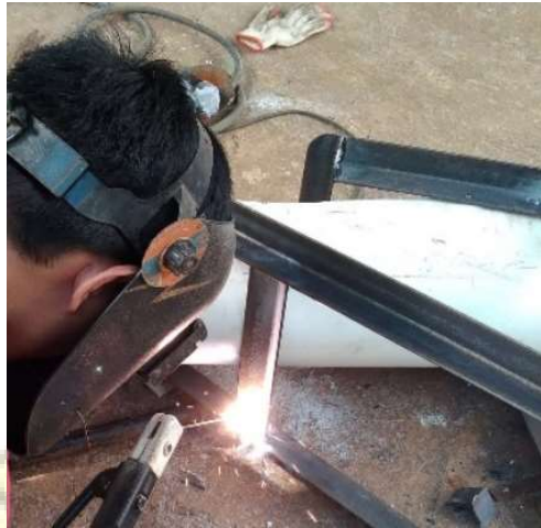
Gambar 8 Pengelasan pada kerangka Turbin Archimedes Screw
