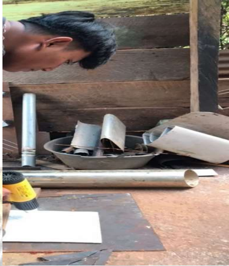
Gambar 4 Pelunakkan pipa PVC menggunakan Heat Gun
