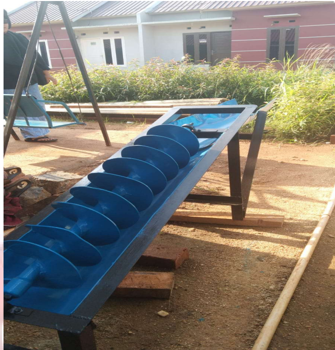
Gambar 10 Hasil dari pengcatan pada Turbin Archimedes Single Screw
