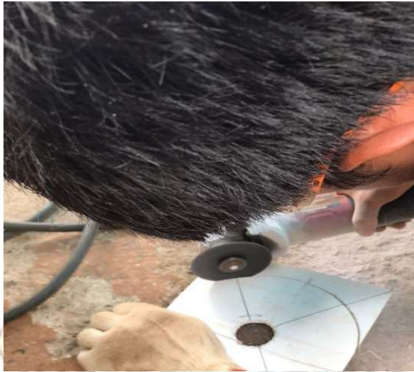
Gambar 6 Pembuatan pola lingkaran menggunakan Gerinda
