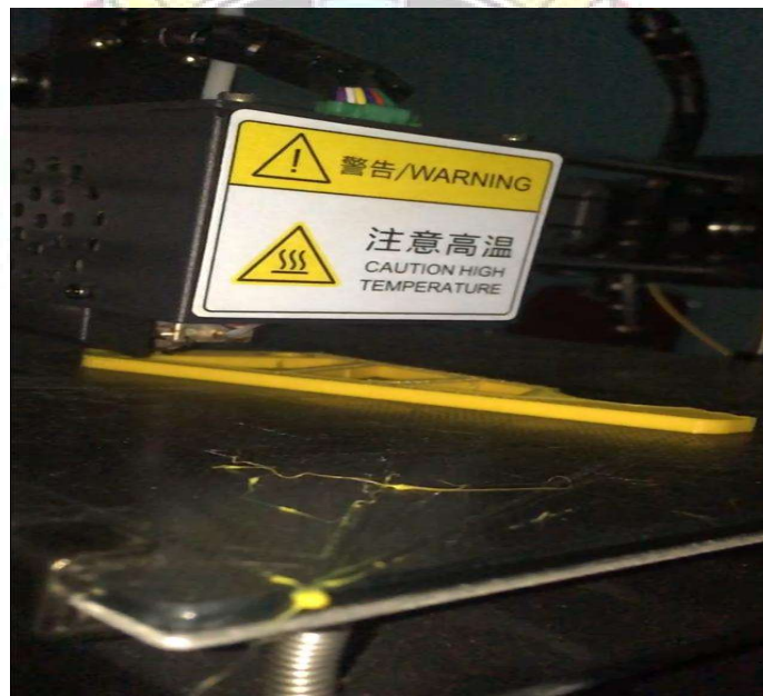
Proses pembuatan sampel menggunakan mesin 3D Printing
