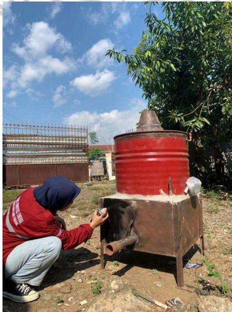
Proses pengecatan Ruang Bakar
