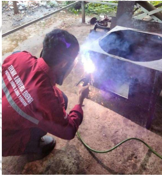
Proses Pengelasan Tiang Tungku
