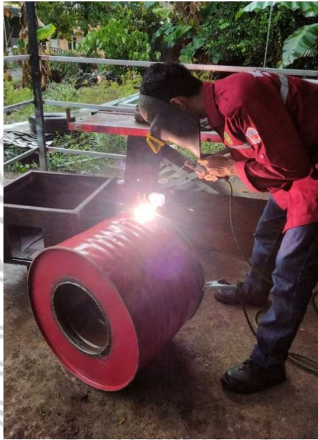
Proses Pengelasan Tabung Air
