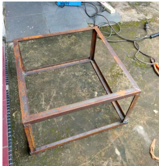
Hasil Pengelasan Rangka Ruang Bakar
