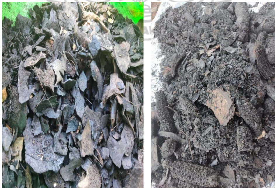
Hasil Pembakaran Tempurung Kelapa dan Campuran
