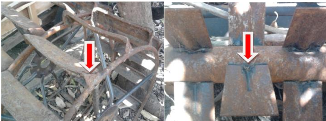
Gambar 2. Bagian sambungan sirip roda besi dan peralatan lain yang sering rusak.
