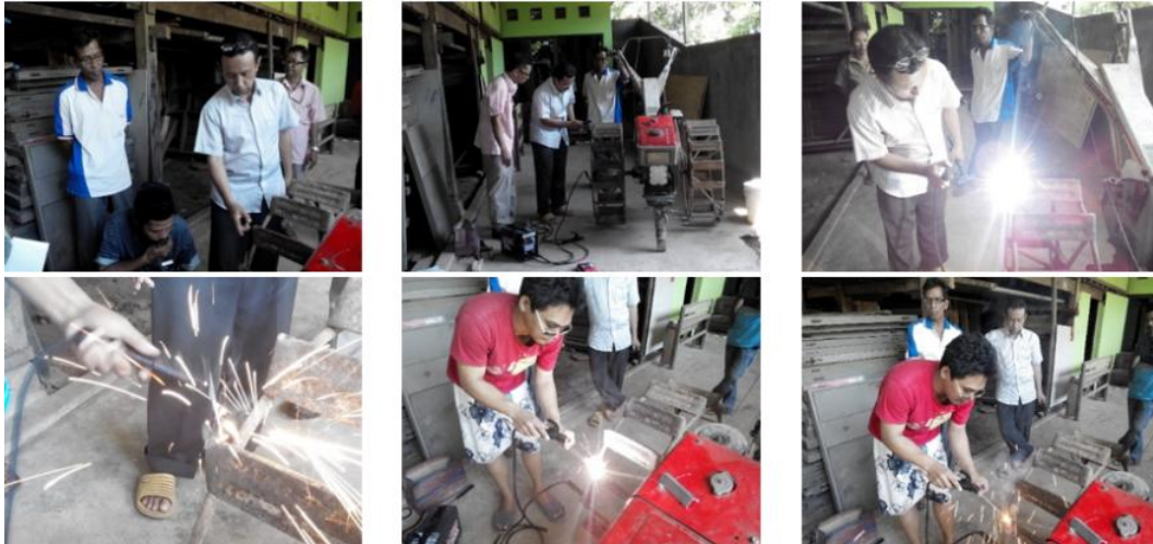
Gambar 8. Proses perbaikan roda traktor yang dilakukan oleh tim pelaksana dan anggota kelompok tani.
