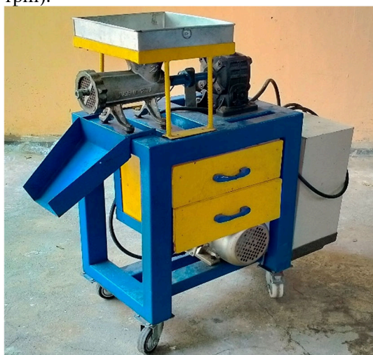
Gambar 1. Mesin pelet sistem ulir daya dan spesifikasinya [1]
