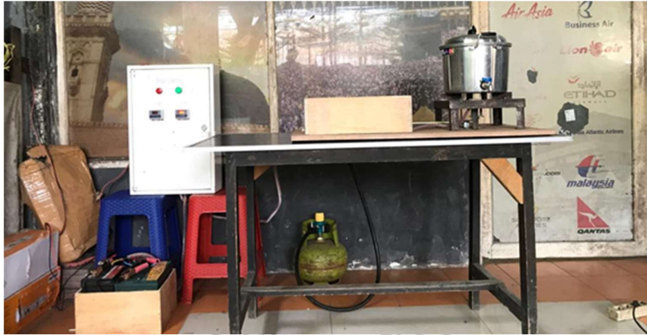
Pengujian pemanas air kontinu sistem hybrid tenaga surya dan gas
