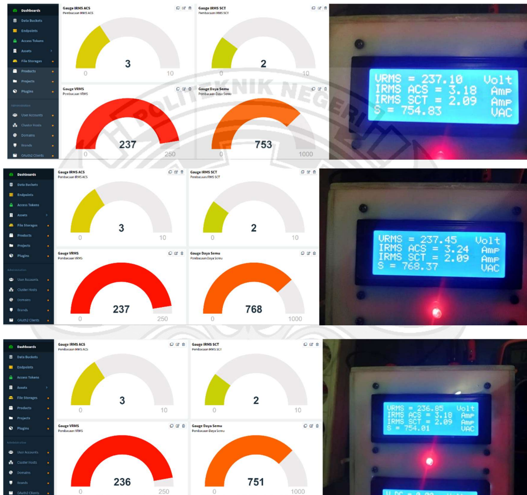
Gambar 4.6 Demo pengiriman data dari Alat Ukur ke Thingier.io yang ditampilkan di dashboard Thingier.io
