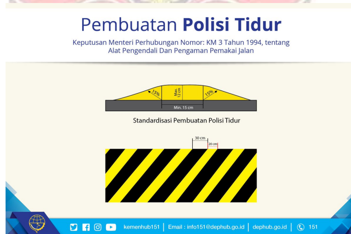
Gambar 2.2 Desain Standar Speed Bump (Pembatas Kecepatan Kendaraan) Sumber : Nugroho, 2017
