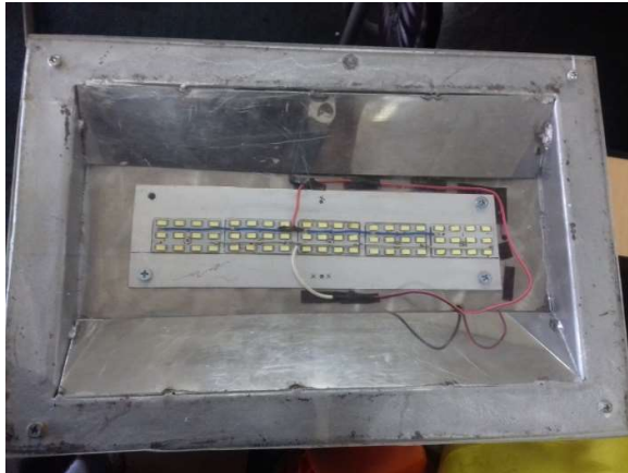
Gambar 4.4 Lampu Jalan dengan Menggunakan Controller
