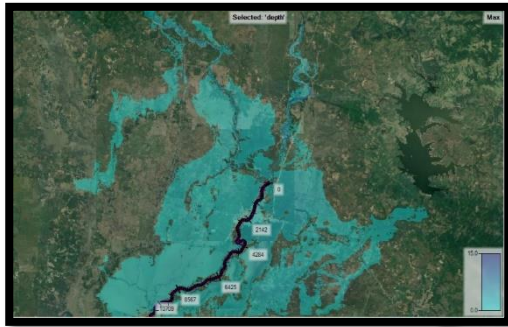
Gambar 4.17. Area Genangan Banjir Kala Ulang 10 Tahun Setelah Rehabilitasi
